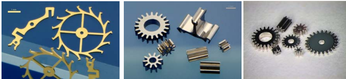
Abb. 8: Vereinzelte Mikrobauteile aus verschiedenen Materialien
