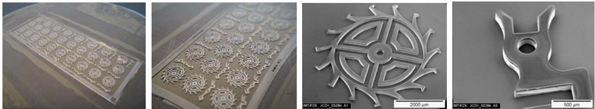
Abb. 7: Mikrobauteile aus Hartnickel für die Uhrenindustrie (unterschiedliche Vergrößerungen; Bauteile noch auf dem 4-Zoll-Wafer fixiert)
