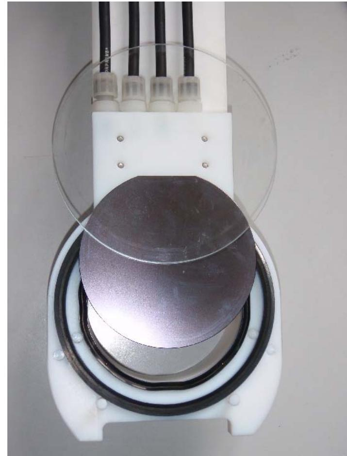
Substrate werden mittels Vakuum fixiert;
