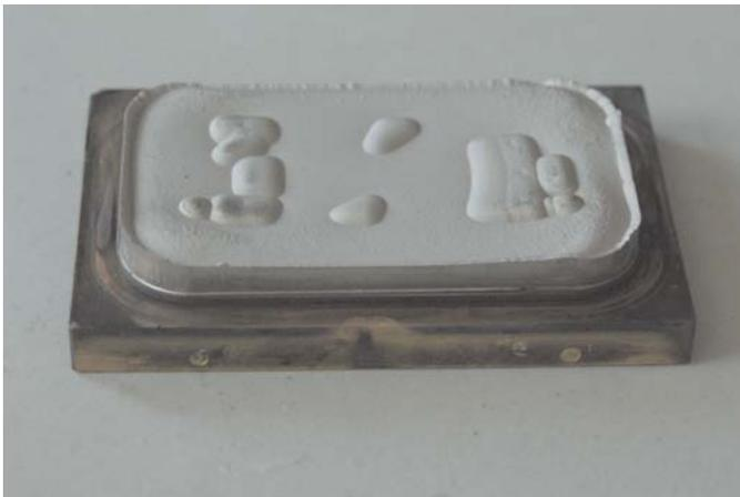
Bild 6a+b. Kupfer-Substrat nach der Galvanoformung in der LIGA-Halterung; a) vor dem Ausbau; b) nach dem Ausbau
